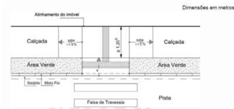
Figura 96 – Rebaixamento de calçada entre canteiros – Exemplo
