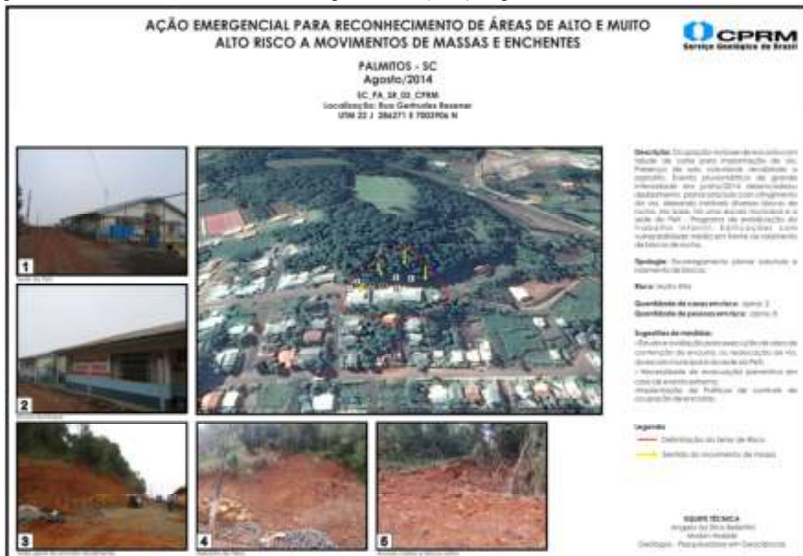
Figura 138 – Setor de risco SC_PA_SR_03_CPRM, com grau de risco muito alto de escorregamento planar e rolamento de blocos identificado por CPRM (2014) no perímetro urbano da sede de Palmitos.
