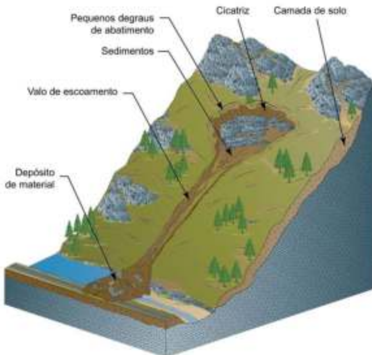
Figura 119 – Esquema do movimento de massa do tipo corrida.
