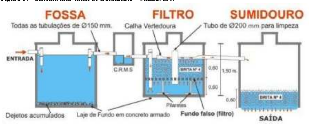
Figura 87 - Sistema individual de tratamento – Sumidouro.
