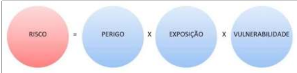
Figura 134 – Definição de risco de desastres.
