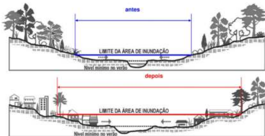
Figura 315 – Alteração do leito do rio com o aumento das ocupações das margens e diminuição das áreas permeáveis.
