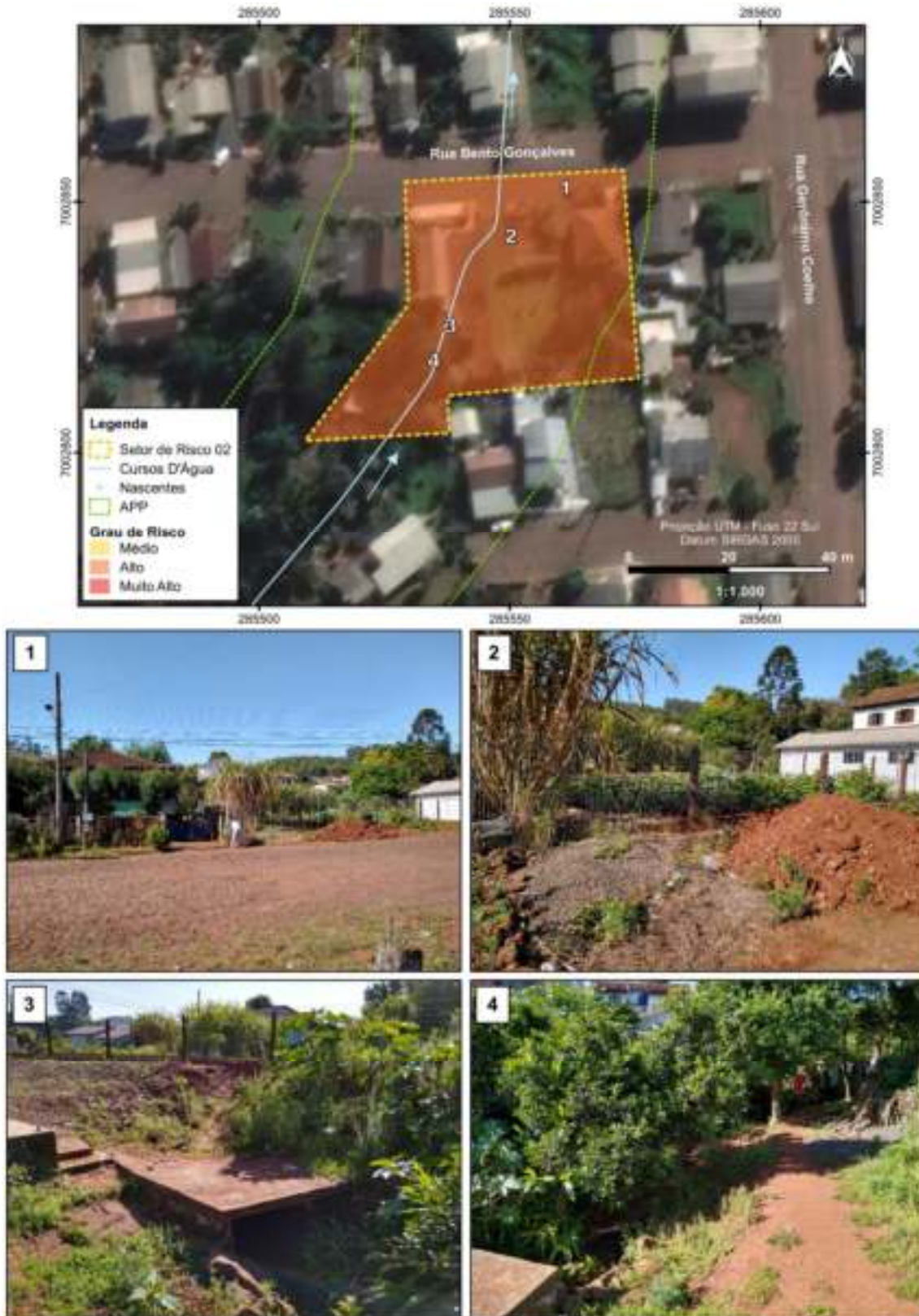
Figura 143 - Classificação de Risco do Setor 02 e fotografias da área: 1 e 2) Vista geral da área onde ocorrem inundações recorrentes, chegando água até a moradia; 3) Local onde o curso d'água passa a ser tubulado e onde ocorre o represamento da água durante chuvas muito fortes, devido o subdimensionamento da tubulação; 4) Margem do curso ocupado por moradia, sujeita a inundações.
