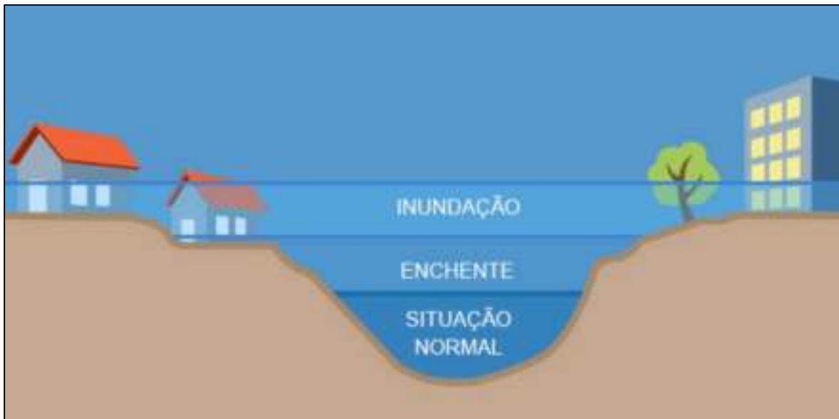
Figura 120 – Perfil esquemático do processo de enchente e inundação.
